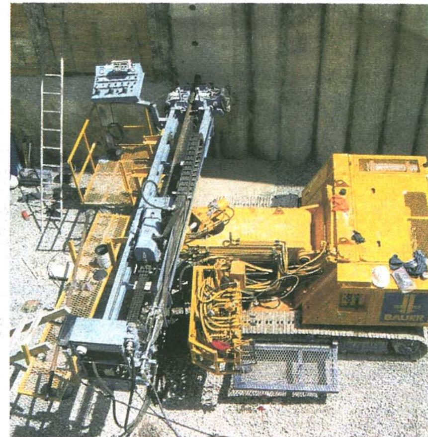
Die Speziallafette wurde von den Tracto-Technikern speziell für diesen Auftrag entwickelt. Dabei wurde der Grundodrill 10 S auf ein in Abu Dhabi stationiertes Bauer-Fahrwerk montiert.
